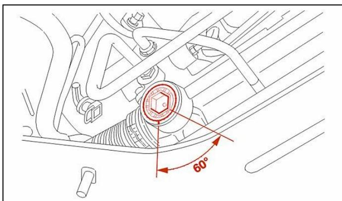
پیچ ضربه گیر را با استفاده از ابزار عمومی [۱] از یک طرف به اندازه  $60^{\circ}$  شل کنید.
