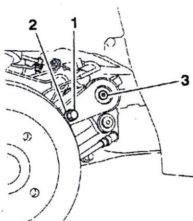
ابزار را باز کرده و واشر (2) و پیچ (1) را در محل مورد نظر (مطابق شکل) قرار داده و پیچ (1) را با گشتاور 3.2 da.Nm سفت کنید در ضمن درپوش (3) را جا بزنید و چرخها را سوار کرده و پیچهای آن را با گشتاور 8.5 da.Nm سفت کنید.
