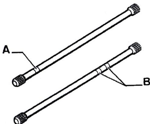
مقدار X را بر روی کمک فنر مصنوعی [2] بر طبق مقداری که اندازه گرفته اید تنظیم کنید تا مقدار ارتفاع ، صحیح حساب گردد و هنگامی که میله پیچشی مجدداً نصب می شود اندازه ارتفاع بر طبق استاندارد باشد در ضمن با تنظیم کمک فنر مصنوعی ارتفاع دو طرف خودرو یکسان خواهد شد.
