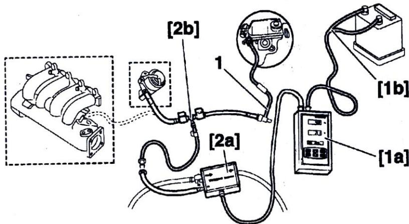
۲-۱- اتصالات مورد استفاده جهت اتصال به کیت یا لوله های فشار قسمت [2b] را به پمپ وکیوم یا خروجی منفیلد ورودی و همچنین به لوله بوستر ترمز (1) وصل نمایید . سنسور جریان [2a] ، واحد DIAL 2000 [1a] و سیستم تغذیه [1b] را مطابق شکل نصب کنید .
