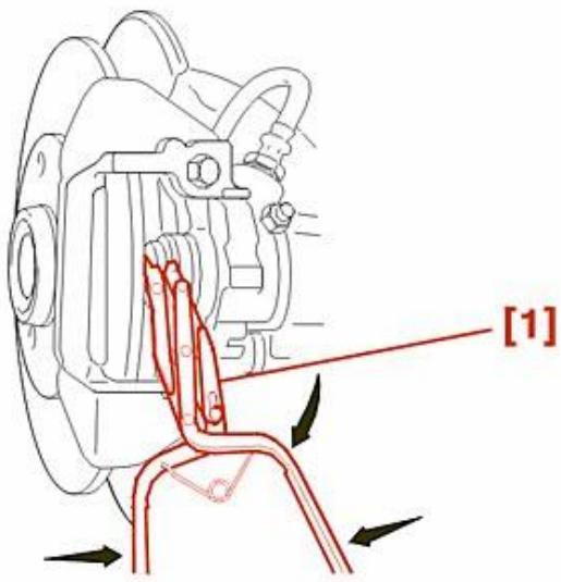
با استفاده از ابزار (۱) پیستون را بچرخانید و آن را بطور کامل بداخل فشار دهید.
