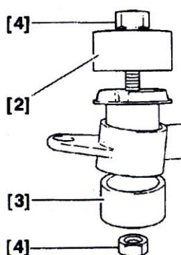
با استفاده از ابزار مخصوص جازن لاستیک ضربه گیر [2] و زیر پرس [3] و پیچ و مهره [4] پایه ضربه گیر و میل تعادل عقب را محکم کنید. پیچها را تا جایی محکم کنید که بوش ضربه گیر به بازویی ثابت عقب تماس پیدا کند. در پایان اکسل عقب را محکم کنید.
