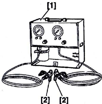
نحوه پر کردن - تخلیه و هواگیری مدار ترمز
