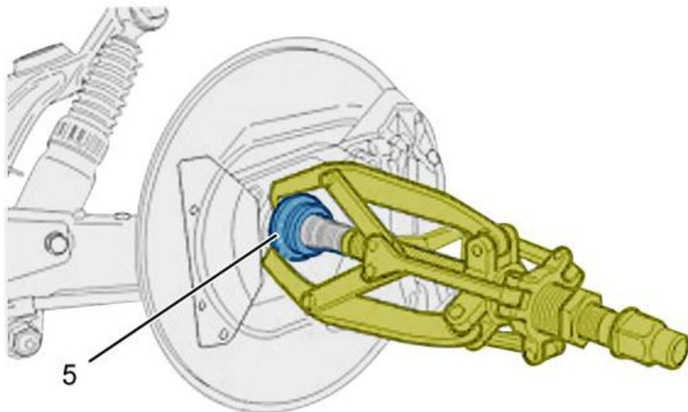
کنس داخلی بلبرینگ (۵) را با استفاده از ابزار [FACOM U20] خارج نمایید.
