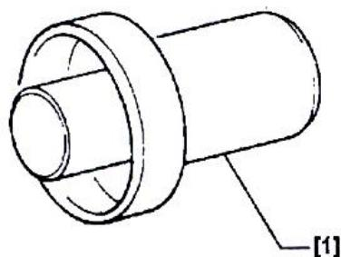
ابزار مخصوص مورد نیاز عبارتند از : جازن و بلبرینگ کش توپی [1] (جزء ابزارکیت تعمیر اکسل عقب با کداختصاصی ۲۵۰۰۳۰۰۱)
