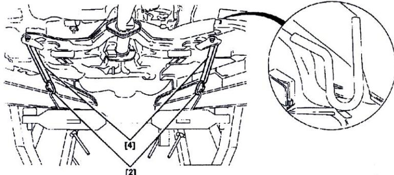
قلاب [4] را درگیر کرده و سپس یوغ [2] بر روی حلقه آن نصب کنید و تنظیم کننده جلوبردی [1] را به یوغ وصل کنید.
