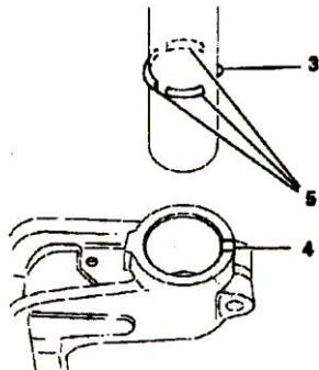
برای سوار کردن مجموعه فنر و کمک فنر بر روی خودرو ، دقت کنید که کمک فنر در محل خود به درستی قرار گرفته باشد . در ضمن از مهره پلاستیکی نو استفاده کنید و خار راهنمای (3) به قرار گیری صحیح قطعه در زاویه و محل قطعه کمک می کند و خار تثبیت (5) مجموعه فنر و کمک را به سمت جلوی خودرو ثابت می کند .
