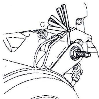
فاصله بین بدنه بازویی متحرک (ژامبونی) را با یک فیلر 1mm تنظیم کنید.
