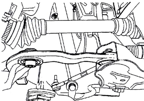
**قفل کنید (از سوکت استفاده شود)****بستن سگدست :**
