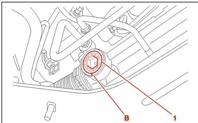
نقطه B را در محل نقطه تطابق گوشه پیچ شش گوش با پیچ ضربه گیر علامت گذاری کنید.
