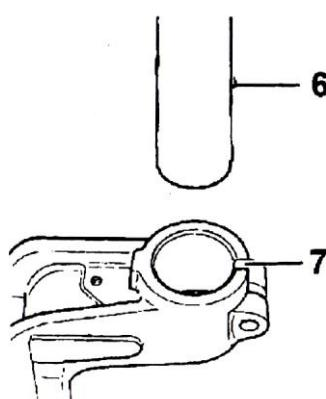
زایده (6) که روی پوسته کمک فنر و شکاف (7) روی سگست راهنمایی است که این دو قطعه بطرز صحیح درهم جا بخورد. از مهره قفل کن جدید استفاده کنید.
