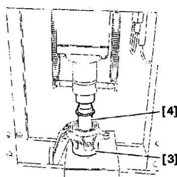
سپس کنس بلبرینگ (3) را در پوسته خودش قرار دهید و صفحه فشاری زیرپرس [3] را روی میز پرس قرار دهید و سگدست را طوری روی صفحه فشاری زیر پرس [3] جا بزنید که در هم درگیر شوند سپس مهره رابط [4] را با کنس بلبرینگ درگیر کرده و توسط پرس بلبرینگ را با فشار خارج کنید.
