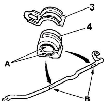
میله موجگیر توسط دو یاتاقان انعطاف پذیر در قسمت زیربندی نگه داشته می شود. و برای ثابت نگهداشتن آن در دو جهت افقی و جانبی لبه های A و B در یاتاقان و میله موجگیر وجود دارد که به ثابت نگه داشتن میله موجگیر در دو راستای افقی و جانبی کمک می کند .
