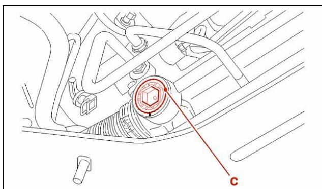
با استفاده از یک پین کوچک در نقطه (C) بین مهره ضربه گیر شانه ای و پوسته، یک شیار اصطکاکی ایجاد نماید.
