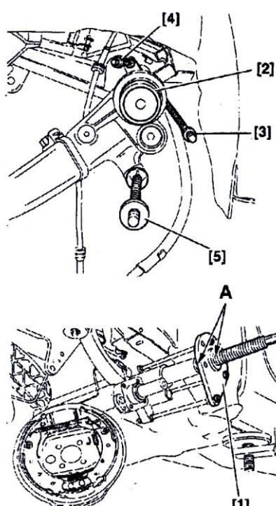
در سمت راست خودرو هم مرکز کننده [2] و پیچ دو سر رزوه [3] بطول ۲۲۵ میلیمتر و پیچ دو سر رزوه [4] بطول ۲۶۵ میلیمتر و پیچ دو سر رزوه [5] بطول ۲۸۰ میلیمتر را مطابق شکل نصب کنید.
