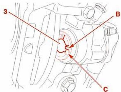
مهم: پیستون (۳) را طوری بچرخانید که شیار (B) بصورت افقی در بالا یا پائین شیار (C) در پیستون قرار گیرد.
