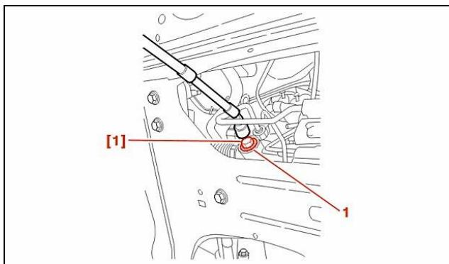
با استفاده از ابزار عمومی [1] مجموعه ضربه گیر شانه ای فرمان را روی پوسته فرمان به طوری بیندید که پیچ شش گوش سفت نشده و فقط استوانه فشاری با میل فرمان در تماس باشد .
