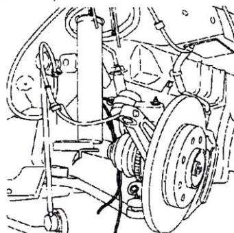
سگدست را با سیم به شاسی بیندید تا از تماس با پلوس جلوگیری شود . سپس مجموعه فنر و کمک فنر و کمک فنر جلو را از روی شاسی باز کنید .
