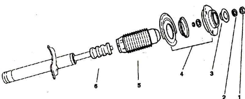
پس از باز کردن مهره کمک فنر (1) واشر و دامپر (3) و توپی و متعلقات آن (4) و گردگیر (5) را خارج کرده سپس کمک فنر را از محافظ آن خارج کنید .
