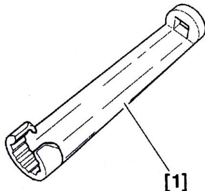
بکس باز و بست لوله فشار قوی پمپ هیدرولیک
