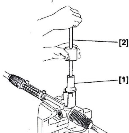
هشدار : هرگز توسط سفت کردن پیچها ، مقسم را جا نزنید بلکه از ابزارهای مخصوص [1] و [2] استفاده کنید
