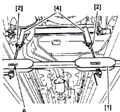
توسط تنظیم کننده جلوبردی [1] سیستم تعليق را فشرده کرده تا ارتفاع از سطح زمین به اندازه  $H_1$  شد متذکر می شویم که ارتفاع  $H_1$  را از سطح زمین تا سطح فلانچ (5) اندازه گیری نمایید.
