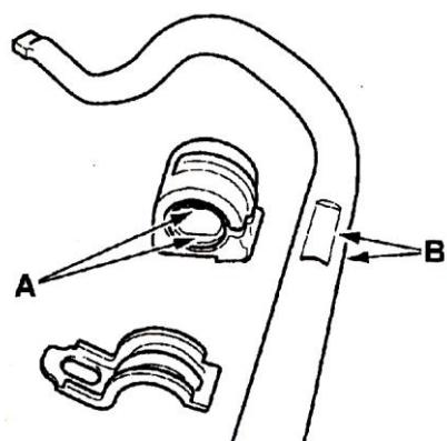
برای جازدن یاتاقان بر روی میله موجگیر دقت کنید که برآمدگی (A) و تورفتگی (B) در هم درگیر شود و هم راستا باشد .
