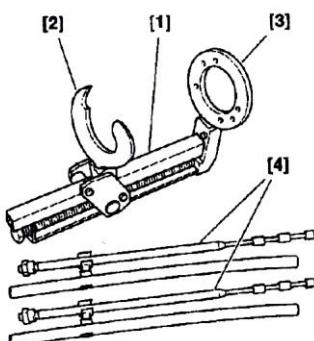
ابزار مخصوص مورد نیاز برای باز و بست فنر و کمک فنر جلو عبارت است از :
