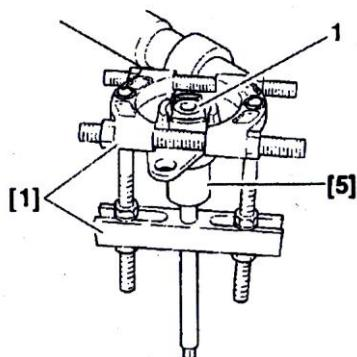
با استفاده از پرس دستی [1] و واسط جازن ضربه گیر [5]
