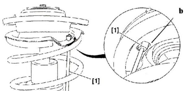
مهره بالایی میله [1] را از قسمت بالای توپی فنر لول بسته و میله [1] را ۹۰ درجه بچرخانید تا سر بیضوی میله عمود بر سوراخ بیضوی توپی (b) عمود شده و درگیر شود.
