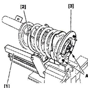
برای باز کردن قطعات مجموعه فنر و کمک فنر ، ابتدا جمع کننده فنر [1] را به گیره بسته سپس حلقه دوم فنر را با چنگال تحتانی [2] درگیر کنید و قسمت بالای فنر هم بدین ترتیب با صفحه بالایی [3] درگیر شده است برای ثابت کردن صفحه بالایی با توپی بالا فنر لول کافی است دو عدد مهره در قسمت (A) بسته شود.
