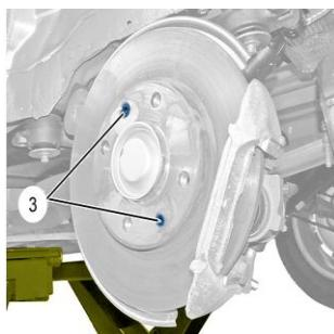
بست کامل ترمز دستی و شلنگ ترمز و کابل سنسور ترمز ABS را باز کرده سپس توپی چرخ عقب را باز کنید.
